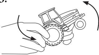
Cuando las llantas del tractor no pueden rotar, la parte frontal del tractor se eleva si está engranado para avanzar.
